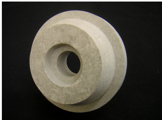
材質：へミサル20t Φ65-Φ15通しΦ24座繰り 加工特徴：円柱形状の座繰り加工
