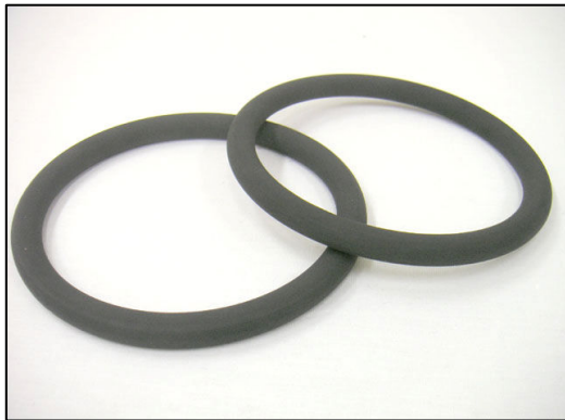
材質：NBR 70° Φ10xΦ120xΦ100 加工特徴：Oリング
