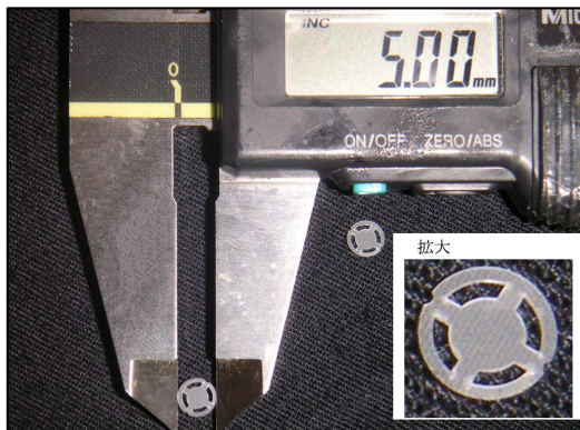
材質：シリコン50 \Phi 5.00\text{mm} x 0.5mm 加工特徴：小さい物の打ち抜き加工
